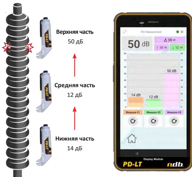
**! Примечание:** Датчик измерительного модуля следует размещать только рядом с изолированной частью устройства. Измерительный модуль ни при каких обстоятельствах не должен контактировать с испытываемым устройством, особенно с проводниками, находящимися под напряжением.
